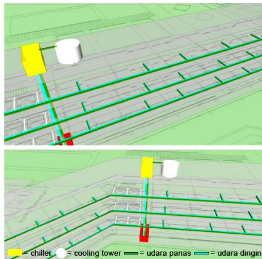
Gambar 2.19 Sistem Utilitas (AC). Sumber: penulis
