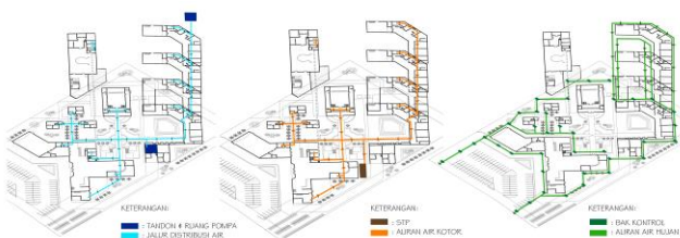
Gambar 2.14 Sistem Utilitas Sanitasi; (ki-ka) Air Bersih, Air Kotor, Air Hujan Sumber: penulis
