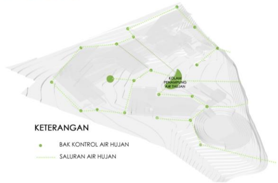
Gambar 2.15 Diagram sistem sanitasi air hujan. Sumber: penulis
