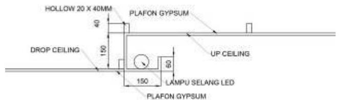
Gambar 2.18 Detail pemasangan lampu selang LED. Sumber: penulis
