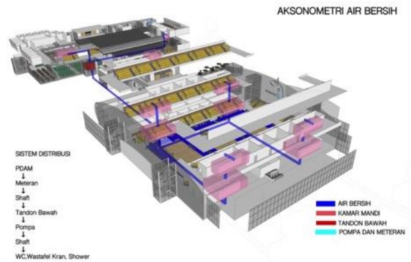
Gambar 2.14 Sistem Utilitas Air Bersih. Sumber: penulis
