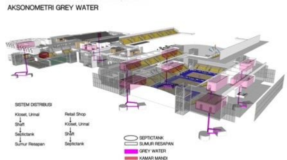
Gambar. 2.16 : Sistem Utilitas Grey Water. Sumber : Penulis
