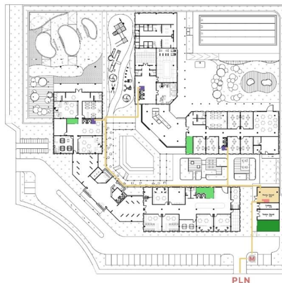
Gambar 2.22. Skematik Utilitas Air Bersih, Air Kotor, dan Kotoran
