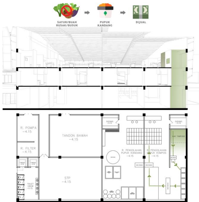
Gambar 2.19. Skema pengolahan limbah sayur, buah, dan palawija
