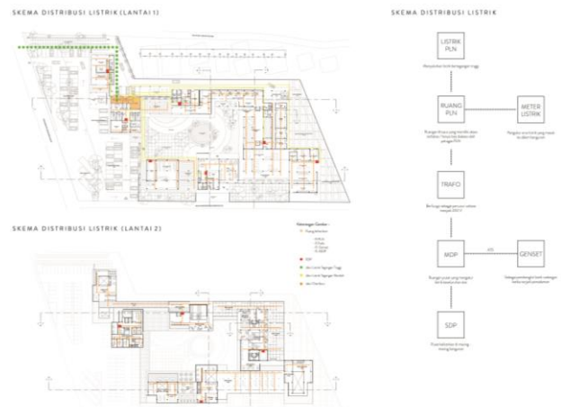
Gambar 2.16. Skema Utilitas Listrik
