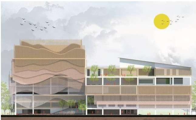
Gambar 2. 8. Tampak timur yang dapat bergerak ( moving façade pada bagian bergelombang)
