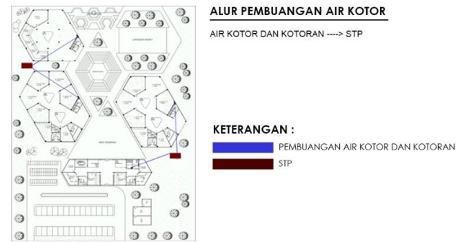
Gambar 2. Skema pembuangan air kotor dan kotoran
