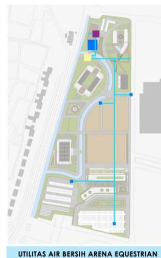
Gambar 6.1. Skema sistem utilitas air bersih.
