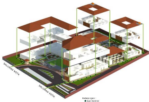
Gambar 2.13. Sistem Utilitas Air Hujan
