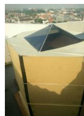
Gambar 6.2 Percobaan menggunakan kaca film 20% (Sumber: dokumentasi pribadi)
