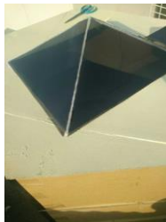
Gambar 6.4 Percobaan menggunakan kaca film 40% (Sumber: dokumentasi pribadi)
