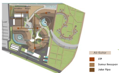
Gambar 5.2. Skema utilitas air kotor
