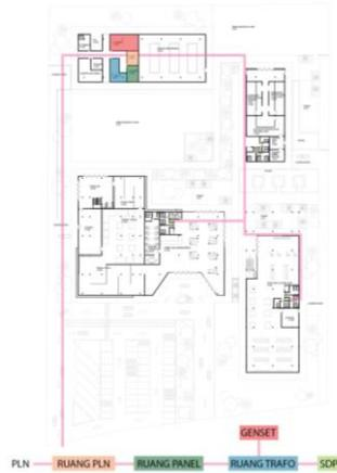
Gambar 2. 23. Diagram sistem utilitas listrik
