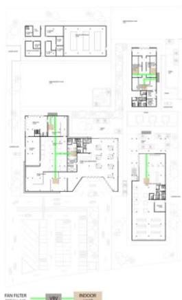
Gambar 2. 24. Diagram sistem AC
