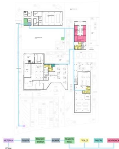
Gambar 2.21. Diagram sistem utilitas air bersih
