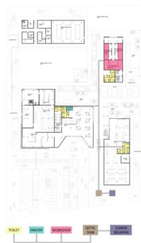
Gambar 2. 22. Diagram sistem air kotor dan kotorann.
