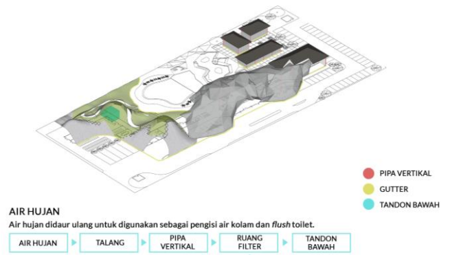
Gambar 2. 21. Skema utilitas air hujan
