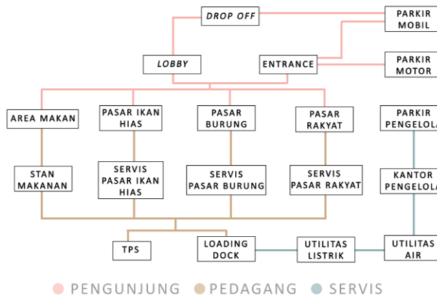
Gambar 2. 6. Skema sirkulasi bangunan
