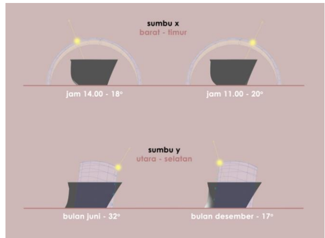
Gambar 2.3. Kemiringan dinding galeri utama
