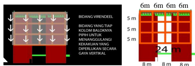
Gambar 2. 31. Detail struktur kantilever depan virendeel .
