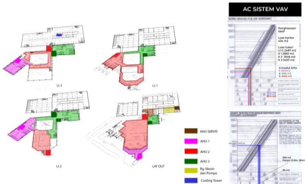
Gambar 2. 33. Utilitas penghawaan aktif VAV.
