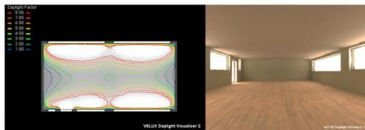
Gambar 1. 28. Simulasi 1 *Daylight Factor*
