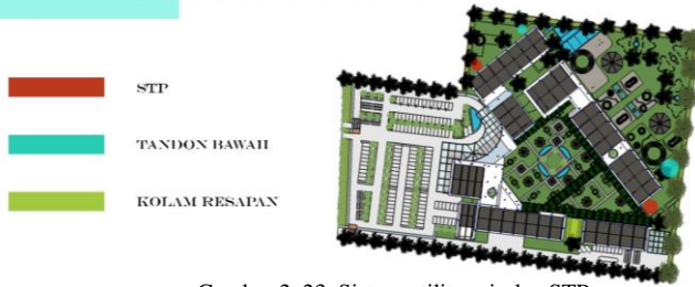
Gambar 2. 23. Sistem utilitas air dan STP
