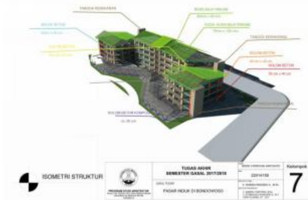
Gambar 2.19. Sistem struktur rangka konstruksi beton.
