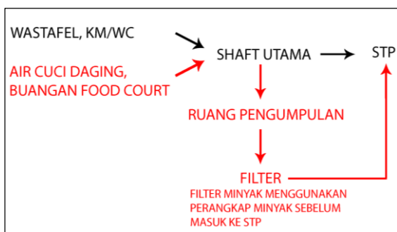
Gambar 3.14. Skema utilitas air kotor
