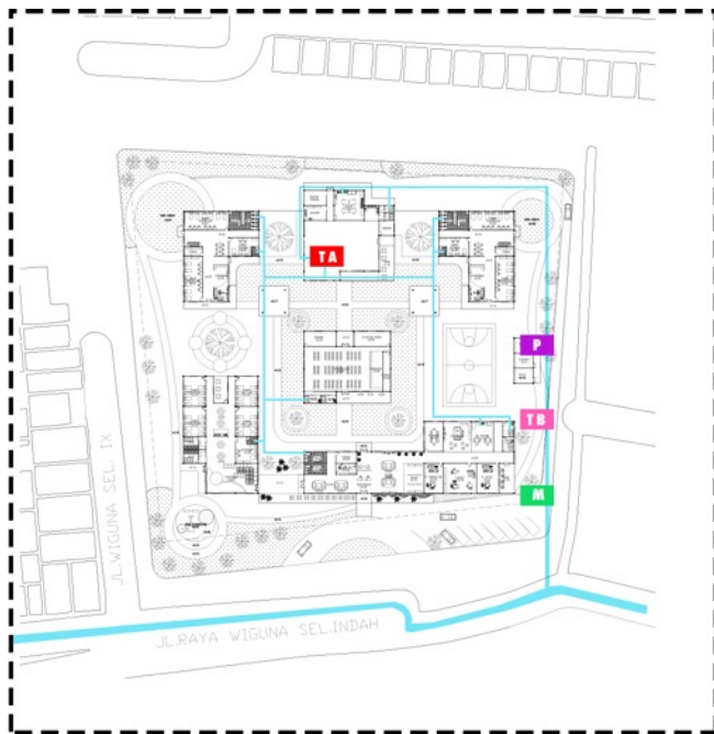
Gambar 2.25. Isometri utilitas air bersih
