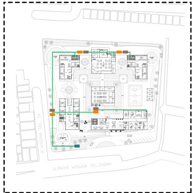
Gambar 2. 26. Isometri utilitas air kotor
