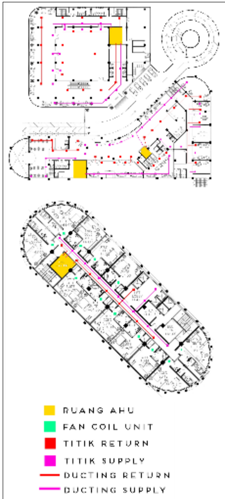
Gambar 2. 14. Diagram skematik sistem penghawaan
