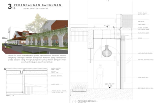
Gambar 2. 21. Pendalaman dan Detail Selasar Penghubung
