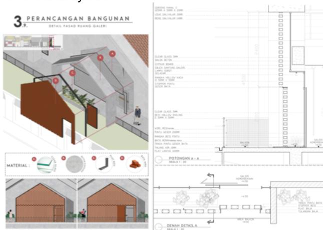
Gambar 2. 18. Pendalaman dan Detail Fasad Bata Berpola
