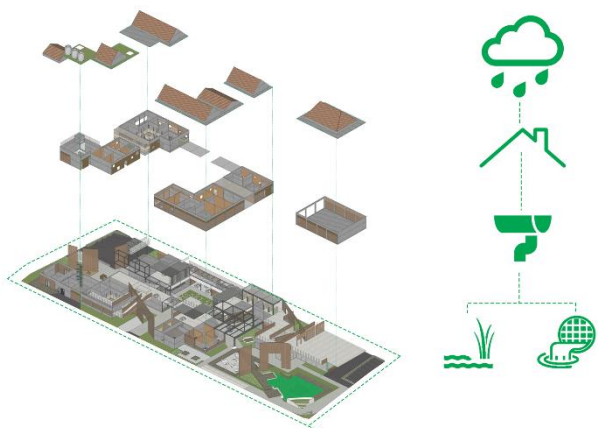
Gambar 2.23. Skema utilitas air hujan
