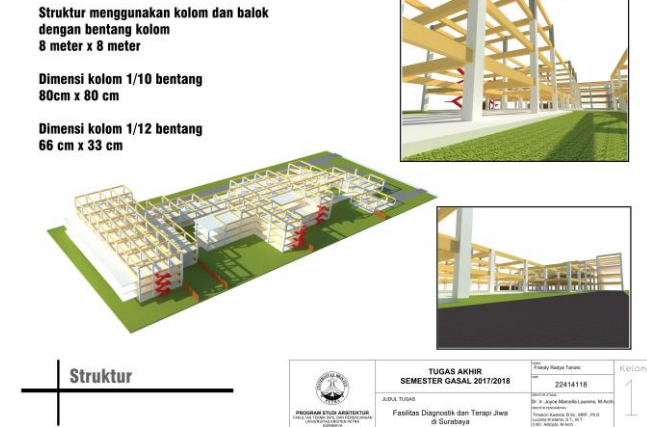
Gambar 2. 21. Kolom dan balok struktural
