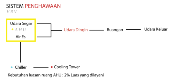
Gambar 2. 31. Skema Sistem Penghawaan Lantai Podium
