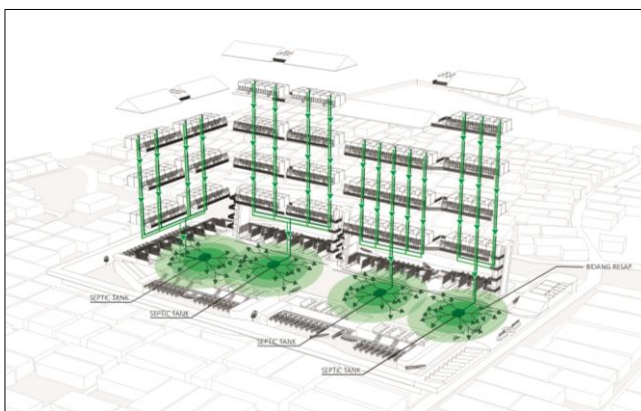
Gambar 3.3.. Isometri utilitas air kotor dan kotoran
