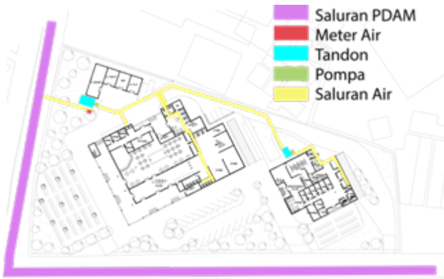
Gambar 22. Utilitas air bersih pada lantai 1
