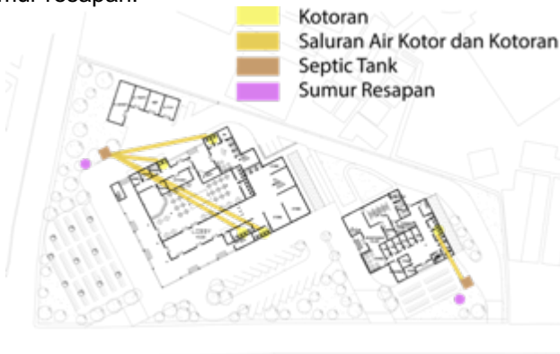
Gambar 24. Utilitas air kotor pada lantai 1
