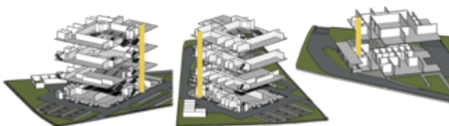
Gambar 25. Utilitas air kotor pada lantai 1
