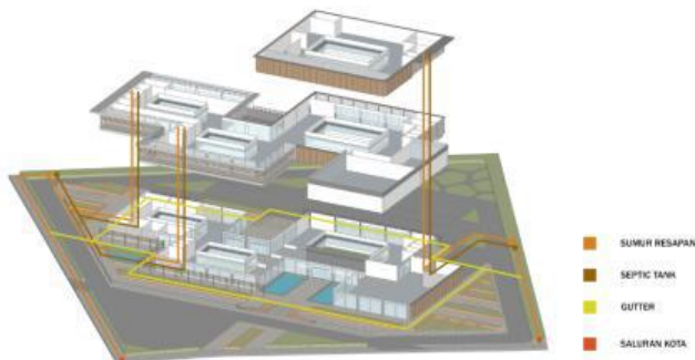
Gambar 2. 25. Sistem utilitas air kotor dan kotoran
