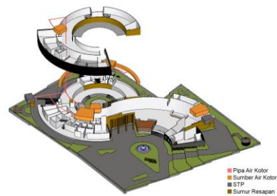
Gambar 2. 28. Sistem utilitas air kotor dan kotoran
