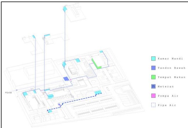
Gambar 2.18. Isometri utilitas air bersih
