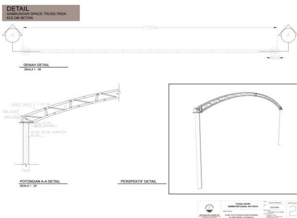
Gambar 2.16. Detail sambungan struktur atap
