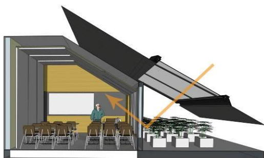
Gambar 2.16. Potongan ruang dan skylight.
