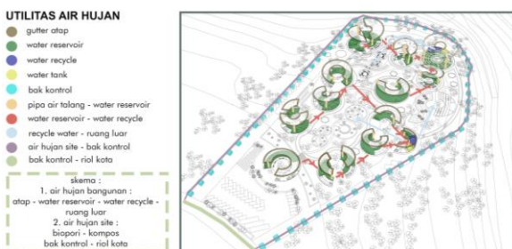
Gambar 3.18. Sistem utilitas air hujan
