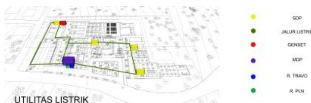
Gambar 2. 20. Sistem utilitas listrik
