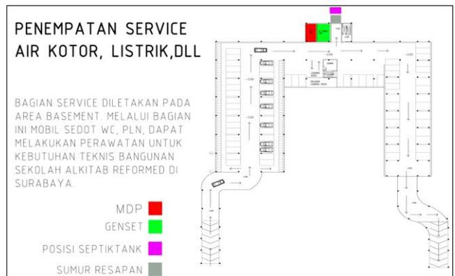
Gambar 2. 26. Skema penempatan genset dan MDP di basement
