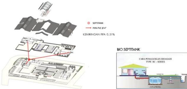
Gambar 12. 3. Isometri sistem utilitas kotoran
