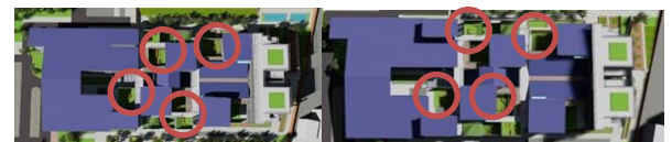
Gambar 2. 5. Simulasi 3D pembayangan matahari dibulan desember
