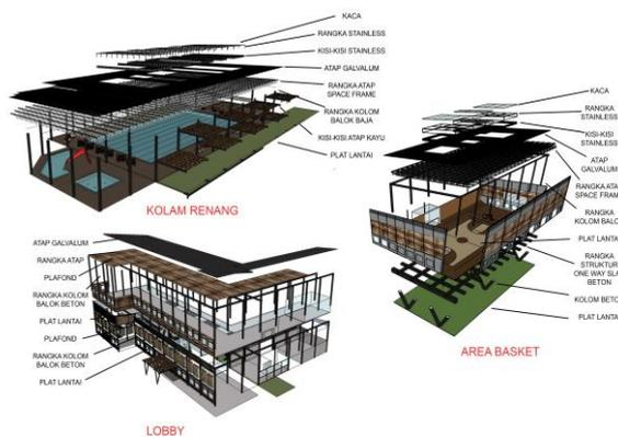
Gambar 2. 16. Isometri Struktur
