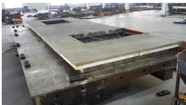
Gambar 2.10. Produksi beton pracetak Sumber: Google Images
