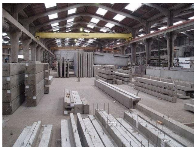
Gambar 2.11. Produksi balok beton pracetak dengan anker terlihat. Sumber: Google Images
