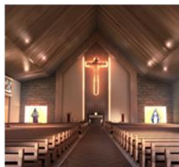
Gambar 2. 15. Perspektif Interior Gereja dan posisi hidden lamp
