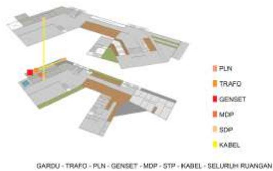
Gambar 3.23. Isometri sistem listrik
