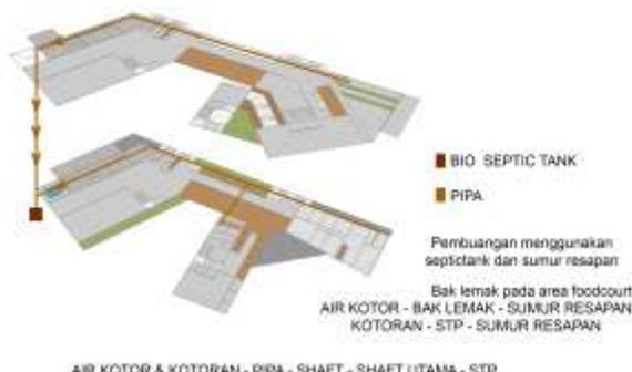
Gambar 3.21. Isometri utilitas air kotor
