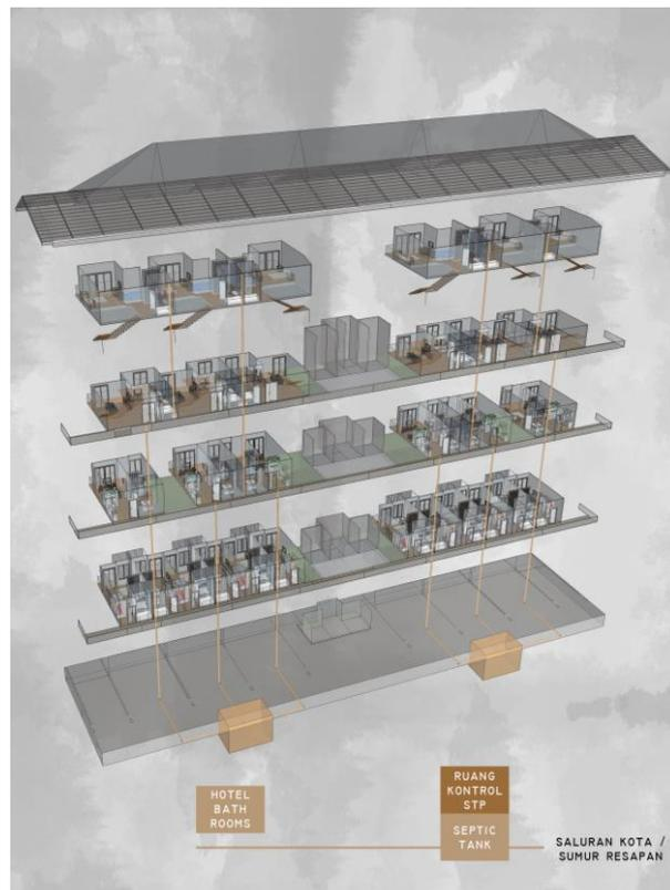
Gambar 2. 27. Isometri utilitas air kotor
