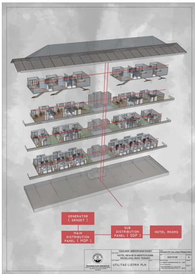
Gambar 2. 29. Isometri sistem listrik
