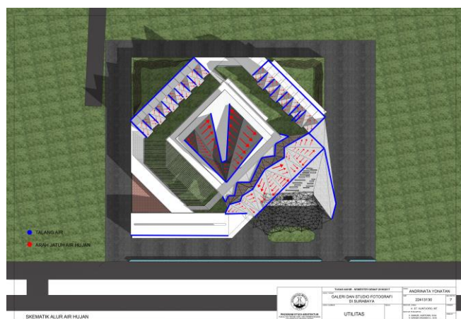
Gambar 2. 14. Utilitas air hujan
