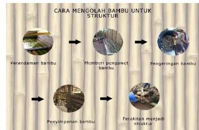
Gambar 2. 14. Cara mengolah bamboo untuk struktur.
