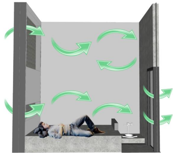
Gambar 2.17. Skematik sirkulasi udara secara prespektif
