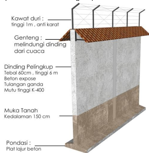
Gambar 2.12. Dinding pelindung luar
