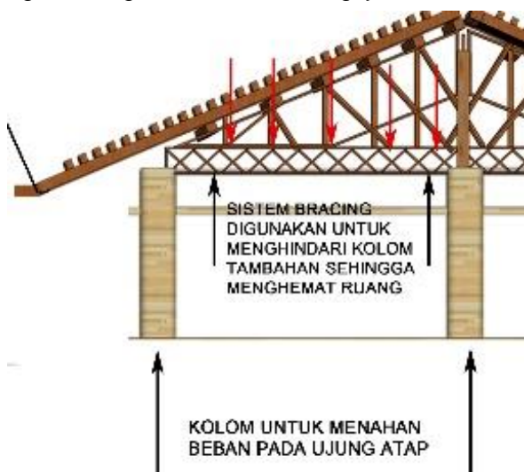
Gambar 2.12. Penyaluran beban pada atap
