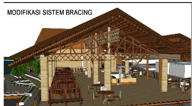
Gambar 2.9. Potongan perspektif atap bangunan utama
