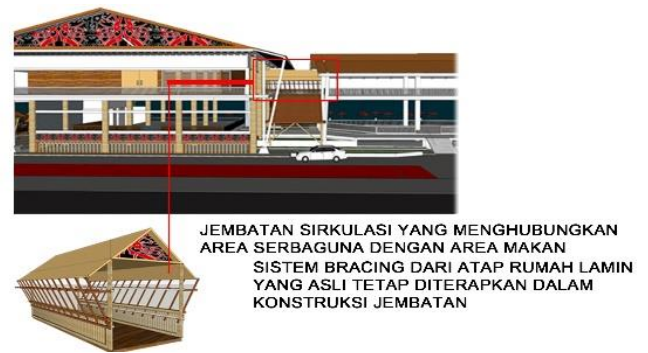
Cambar 2.11. Jembatan penghubung 2 massa
