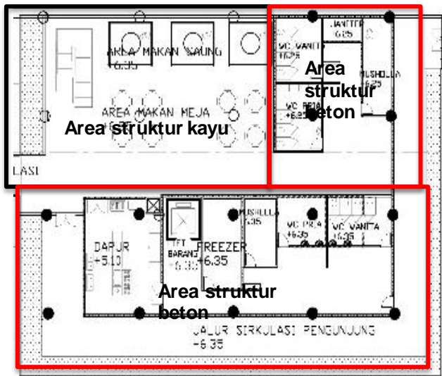
Gambar 2.18. Denah perbedaan sistem struktur
